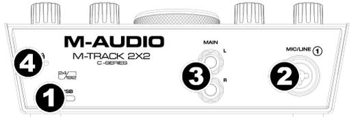
2. **コンボ入力端子①** : この端子に、マイク、ギターやベースのアクティブピックアップ（ローインピーダンス）の信号、ラインレベルの信号などを接続します。マイクには、XLRまたは1/4" TRS ケーブルを、ギターやベースのアクティブピックアップには、標準的な1/4" TS ケーブルを、ラインレベルの信号には1/4" TRS ケーブルを使用します。入力された信号は、LEDメーターに表示されます。
